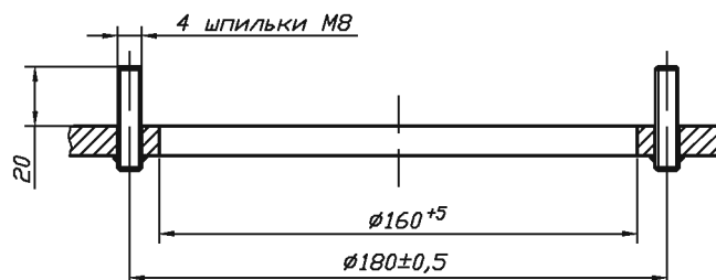
Рис. 13 ППП для АПЖ с датчиками уровня, температуры, плотности и установкой на один фланец
